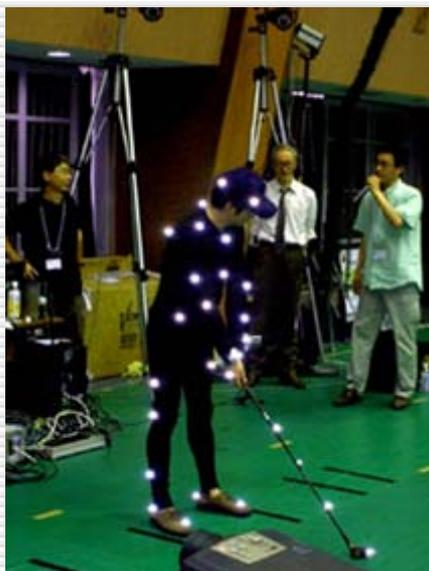
最初の注目点は、洗練されたソフトウェアです。Eagle Digital Systemは、カメラ位置、ボリューム空間、カメラの視覚範囲等のわかりやすい視覚化、完全なリアルタイムでのスティック表示、関節角度のグラフ表示等の実現がなされ印象的でした。VICONは、豊富なソフトウェア、リアルタイム計測、隠れ点に対する処理等が用意され、動作計測におけるユーザの労力軽減が期待できます。スポーツ動作の計測では、パフォーマンスを向上させるために、対象者に結果を見せながら、指導を行うことも必要となります。その場合、Eagle Digital SystemやVICONに代表されるリアルタイムシステムは非常に有用です。
