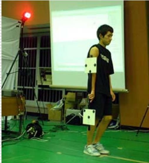
2. 図2のような棒をもった被験者が図1の路面を図3のように歩きました。棒の両端につけたマーカーク間の距離を歩行分析システムにて計測し、実際の値と比較して精度を検定しました。結果を表1に示します。Ave. Absは誤差の絶対値の平均値。Max. Err+は最大値－真値。Max. Err-は最小値－真値。（表2、表3も同様）
